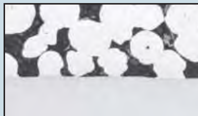
なじみ運転が終わって、ある程度の運転時間経過後の DDK05ドライベアリング断面写真
